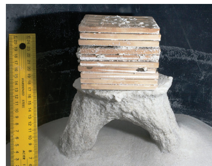
Výsledek modelování střelečského pískovce – perfektní experimentální brána, vytvořená opakovaným zaplavitím zatíženého bloku s obdélníkovým otvorem
